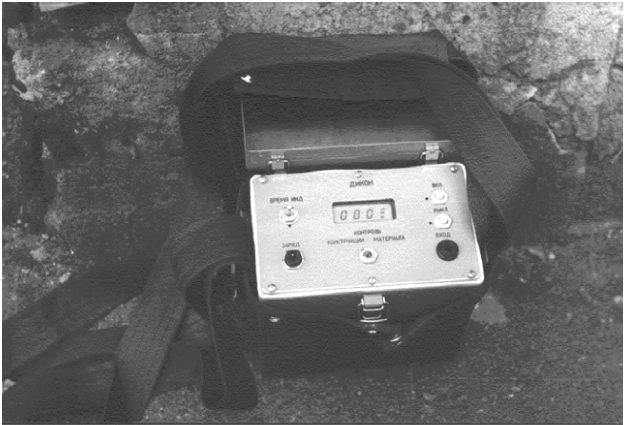
Рис. 2 – Зовнішній вигляд цифрового віброакустичного індикатора “ДИКОН”
